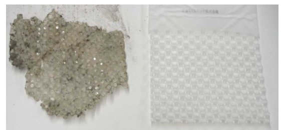
(a) 土中劣化 (b) 気中劣化
