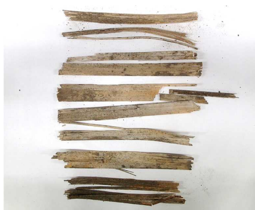
写真-2 掘り起こし後の鉛直ドレーン材
