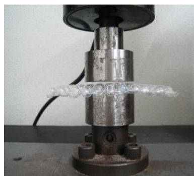
写真-4 圧縮試験の状況
