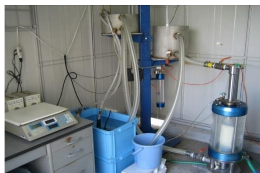
写真-5 透水試験の状況
