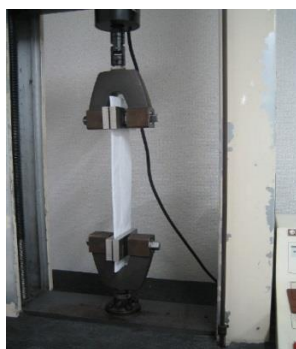
写真-3 引張試験の状況
