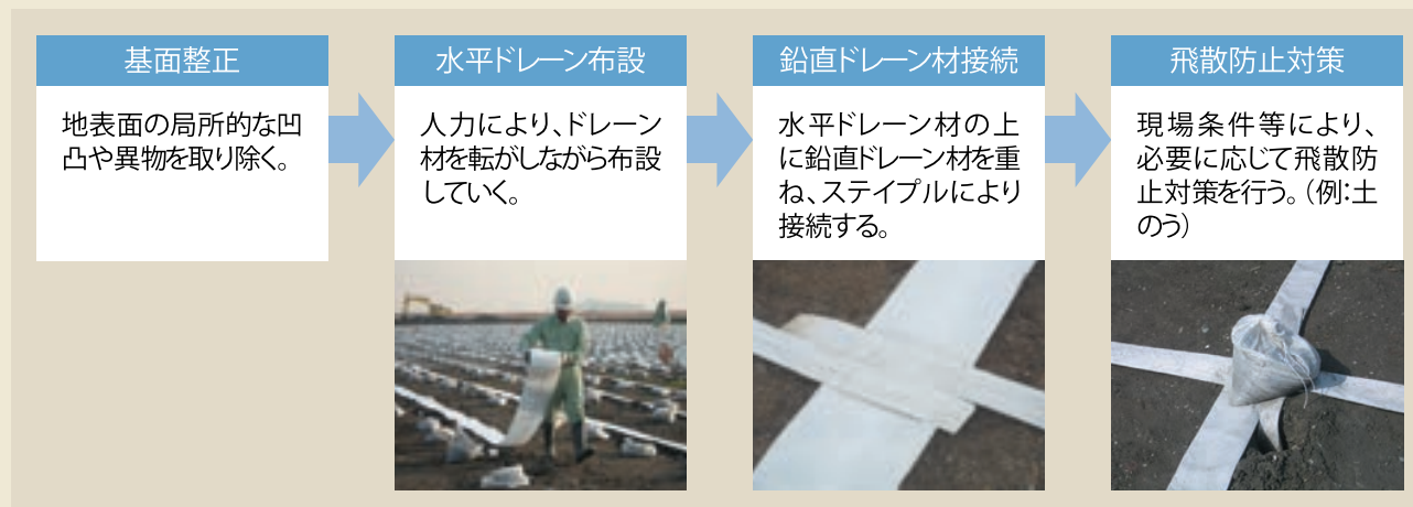
水平ドレーン施工手順
