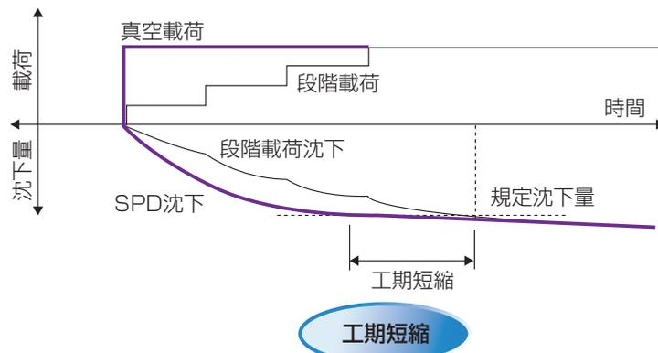
従来の盛土工法では段階載荷となるため載荷完了までに時間を要します。
