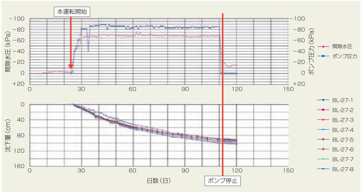
上段はポンプ圧力および地中間隙水圧、下段は地表面沈下量のグラフです。ポンプ圧力は80kpa、間隙水圧は70kpa程度を示しています(設計:60kpa)。沈下量はブロック内各点とも同様の傾向を示しています。
