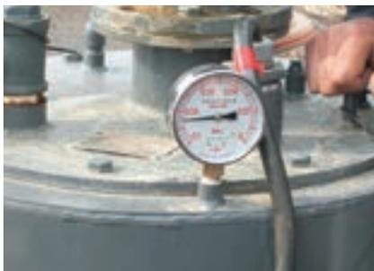
計測装置(例)：圧力計
