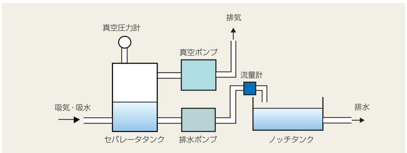
真空設備は空気を含む排出水の気水分離装置（セパレータタンク）と気体排出用の真空ポンプ、液体排出用の排水ポンプから構成されています。
