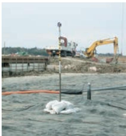
計測装置(例)：沈下板
