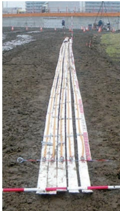
計測装置(例)：間隙水圧計
