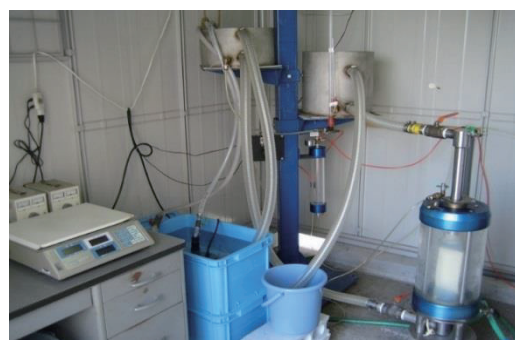
写真-5 透水試験の状況
