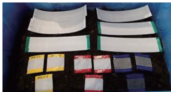
写真-2 供試体の埋設状況 (敷設後、土壌投入前)
