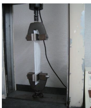
写真-3 引張試験の状況
